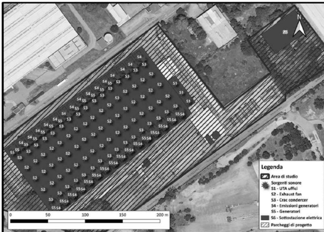
Estratto dalla relazione acustica – si notino i generatori “S5” il cui numero è di 16+10=26
