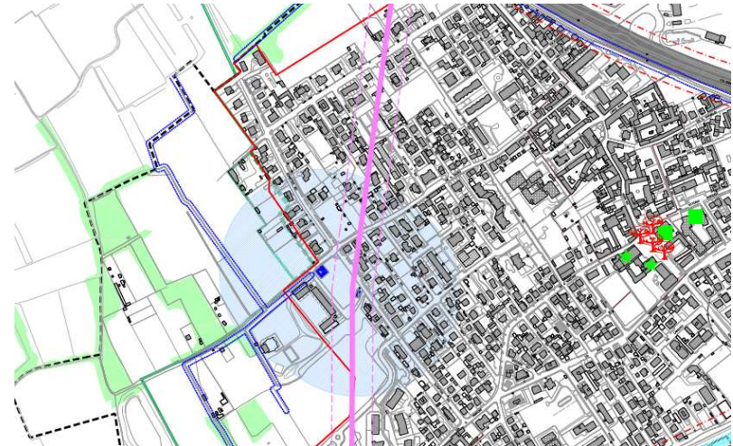
Linee di elettrodotto e individuazione della fascia di prima approssimazione di 40 metri della linea a 220kV che attraversa l'ambito del Piano Attuativo (fonte: Rapporto Ambientale VAS della Variante generale 2021; Variante 2021 - tavola DA02).
