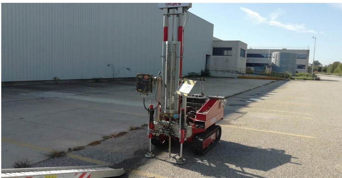
Prova di permeabilità tipo “Lefranc”
