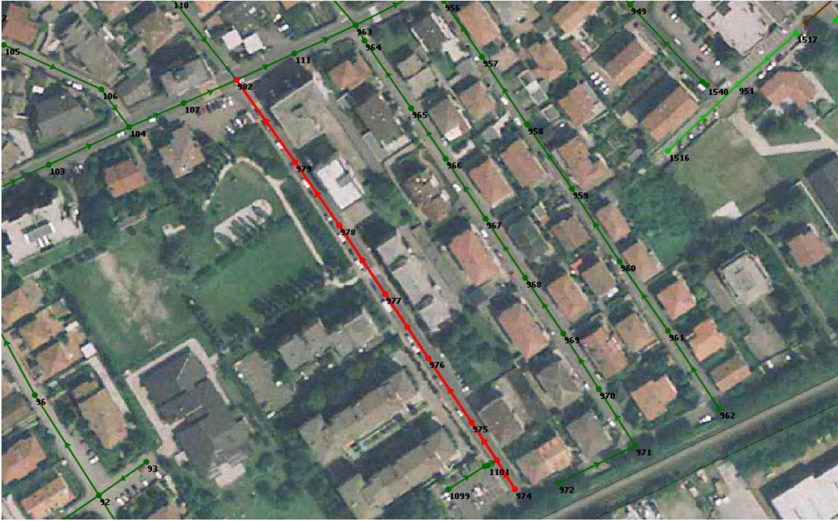
Figura 65 –Tracciato di rete meteorica in progetto lungo via Genova
