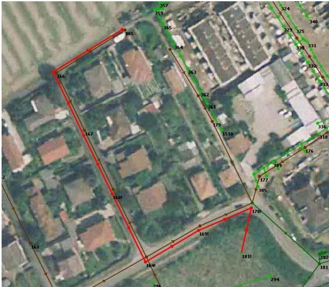
Figura 71 –Tracciato di rete nera in progetto lungo via Rovereto, via Gorizia e via Treviso
