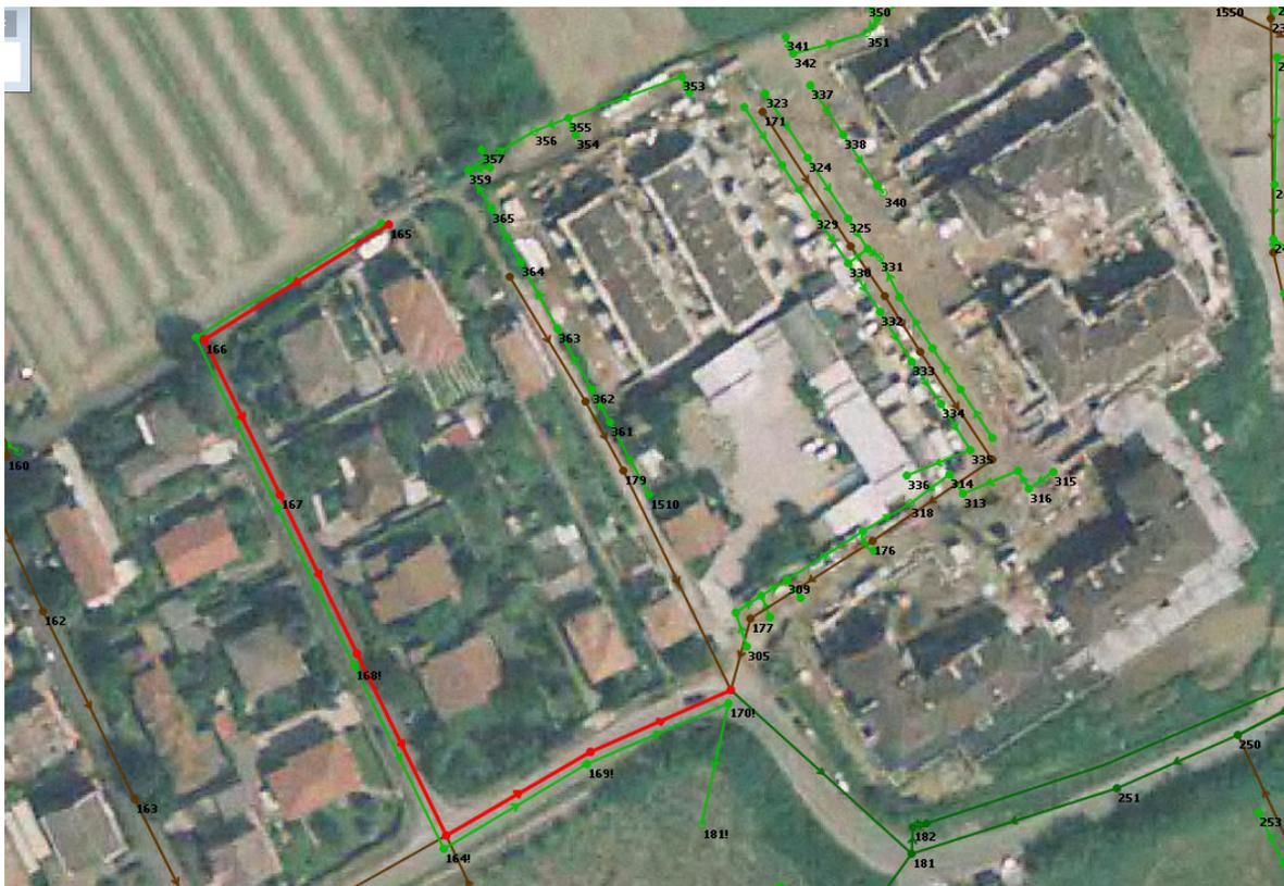
Figura 70 –Tracciato di rete nera in progetto lungo via Rovereto, via Gorizia e via Treviso
