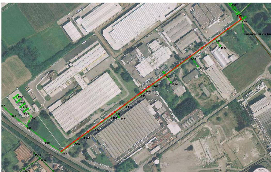
Figura 63 - Planimetria rete neradi via Vanzago e via delle Industrie
