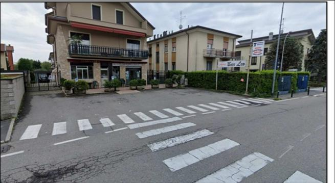
Un ampliamento di soli 40 cm del marciapiede rende ancora possibile l'incrocio di mezzi pesanti, ma restituisce la transitabilità del marciapiede per le carrozzine.
