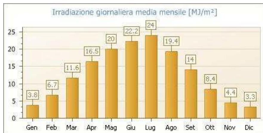
Fig. 1: Irradiazione giornaliera media mensile sul piano orizzontale [MJ/m 2 ]- Fonte dati: UNI 10349 - Località di riferimento: MILANO (MI)/PAVIA (PV)
